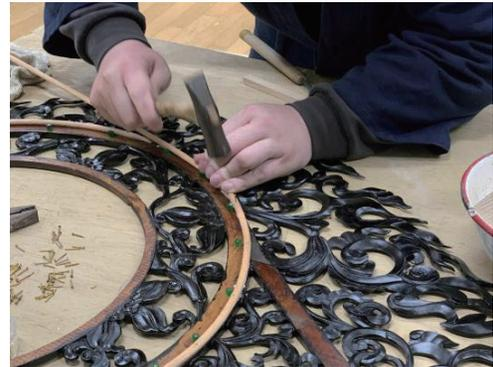
[図 16] 曲木で頭光の部材を組み合わせる
